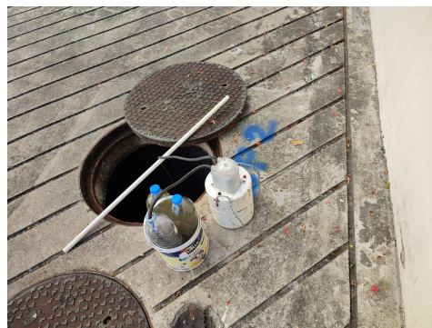
ภาพที่ 3-28 การเก็บตัวอย่างน้ำทิ้งที่บ่อเกรอะและบ่อพักน้ำใส
