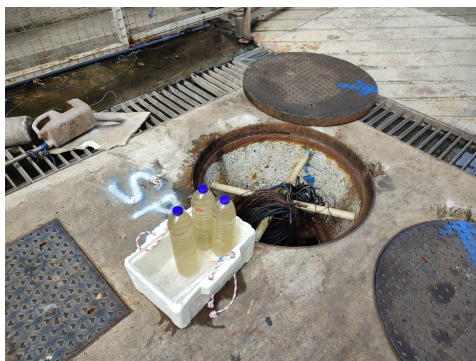
ภาพที่ 3-28 การเก็บตัวอย่างน้ำทิ้งที่บ่อเกรอะและบ่อพักน้ำใส
